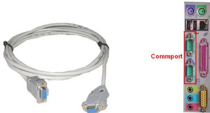
สาย RS232 และ Commport ของเครื่องคอมพิวเตอร์
